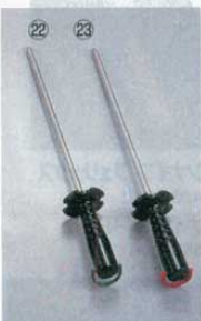
スチール棒 ダイヤ ダイヤ部分の長さ: 10X305mm ②② #1200 仕上用 緑 30cm (6180800) ②③ #600 中仕上用 赤 30cm (6180900) ※研ぎ上げ時間が従来の3分の1で済みます。
