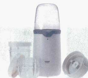
② ミルサー IFM-700G イワタニ (3686500) φ98×H260mm 重量: 1,360g 容積: 400cc 消費電力: AC100V (50Hz/60Hz)・200W 材質: 本体外装/ハイインパクトスチロール カッター部成形品/POM=ポリアスチール樹脂 カッター/ステン レス304 カッター部パッキン/シリコンゴム スイッチカバー/AS 樹脂 容器/ソーダガラス 付属品: パウダー容器(容積230cc)、容器用フタキャップ、取扱説明書
