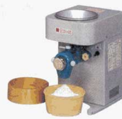
④製粉機 A-7型 卓上型(粉エース) (6921200) 外寸: 220×330×H355mm ホッパー容量: 1.2ℓ 電源: 単相100V/170W 重量: 11kg 処理能力: 乾燥生大豆 2~3kg/時間 付属品: フルイ(60メッシュ)、容器、ブラシ ※粉のキメはワンタッチハンドルで粗〜細調節をします。
