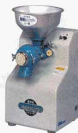
③製粉機 L-S型 やまびこ号 (6921100) 外寸: 280×365×H540mm ホッパー容量: 4.8ℓ 電源: 単相100V/250W(コンデンサー付) 重量: 22kg 処理能力: 乾燥生大豆7kg/時間 付属品: フルイ(60メッシュ)、工具、ブラシ ※ホッパーが大きく、材料を何度も追加する手間がいりません。
