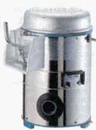
②皮ムキ機 HP-5S 球根用 プロシェフ (0805100) 定格時間: 連続 外寸: 380×450×H540mm 電源: 単相100V 50/60Hz 消費電力: 180/165W 重量: 32kg 能力: 4~5kg/2~3分
