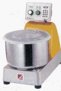
⑧卓上型デジタル麺ローダー DK-21V 50Hz (8599900) 60Hz (8599910) 外寸: 288×475×H445mm 電源: 単相100V 50/60Hz 消費電力: 120W ボール満容量: 9.0ℓ 回転数: 100~300rpm(インバーター変速) コード長さ: 3m 質量: 20kg ※水10割蕎麦の水まわしが短時間で確実にできます。 ※専用攪拌子(エスカルゴ)で仕込み時間の短縮がはかれます。 ※ボール、エスカルゴ(攪拌子)は容易に脱着ができます。 清潔に保つことができます。 ●手軽に本格的な蕎麦打ち。職人も納得の出来栄です。
