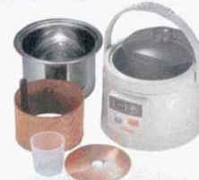
⑭ マイコン電気発芽器 HP-70 発芽美人 (6873400) 220×240×H200mm 電源: 単相100V 消費電力: 37W 容量: 1.9ℓ ●マイコン制御で発芽に最適な温度をコントロールして、22時間で活性化したおいしい「発芽玄米」に。あとはお手持ちの炊飯器で炊飯でき、お好みの割合で白米との混合炊飯もできます。 ※「玄米」を発芽させ「発芽玄米」をつくる専用機能です。炊飯ジャーとしては使用できません。 発芽玄米の作り方 1.本体に内なべ、発芽用銅フレームをセットします。 2.水洗いした玄米を内なべに移します。 ※玄米を7合 (1.8ℓ) 発芽させると、水分を含み2~3割増え1升位 (1.8ℓ) の水量になります。 3.内鍋に水を入れます。 4.発芽用蓋をした、発芽用ふたをして、電源ON。
