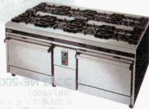
⑦ ガスレンジ OZ2LB-180R 両面式 ※オープンが中がトンネル状ですので、厨房室の中央に設置すれば両側から使用出来ます。 ※オープン立消え安全装置付。
