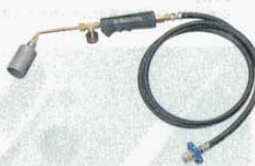
⑭ ハンドトーチガスバーナー KB-45-1-2 (3115700) 火口サイズ: φ45×103mm ガス消費量: 25.9kW (LPG) 火炎温度: 1,200℃ ホース: 2m ※LPガス専用です。
