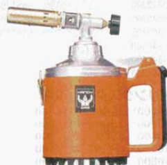
① ガストーチ 450 AG オート 235×125×H228mm (5884600) 重量: 670g (ボンベ未装着時) ※ボンベ別売、②をご使用下さい。 ※逆さ使用可能。
