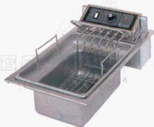
⑧ フライヤー FEF9B 50Hz (7561100) 60Hz (7561200) ●強力なヒーターを槽内に投入し、油を直接加熱するので油温の立ち上がり早い“ヒーター投げ込みタイプ”です。 ●ガスを使えない厨房でも使用でき、しかも、コンパクトな設計なので幅広く利用できます。 ●油温の低下が少なく冷凍食品の連続調理が可能です。 ●6kWの高性能細管ヒーターを使用しています。 ●サーモスタットで油温をコントロールでき、空焚き防止サーモも付いています。
