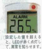
設定した値を超えると、LEDが赤く点灯して、異常を知らせます。
