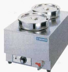
⑦ ウォーマー TEW-A型 卓上(湯煎式) (8364500) 丸型ポット(6.5ℓ) ×2 外寸: 350×550×H260mm 電源: 単相100V/900W リード線2m・プラグ付: 2P-15A 排水コック: 15A 重量: 14kg
