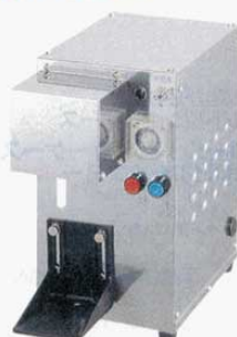
⑩ 定量充填機 KBB-1 T型 小分太 (5467900) 230×390×H390mm 電源：単相100V 50W 能力：3,600cc/分 60cc/秒 吸入可能容器：口径10mm以上 本体ステンレス製 ●各種容器への定量充填に最適です。 ●吸い上げはパイプを差し込むだけ。 ●タイマーを量に合わせて設定、つぎたしも 手動ボタンを押すだけで簡単です。
