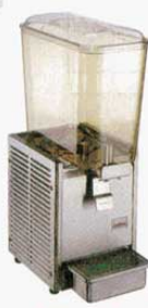
⑬ ドリンクディスペンサー HD-15 ホット (6740900) 外寸: 250×395×H695mm 重量: 5.8kg 容量: 19ℓ 材質: 容器/ポリサルフォン 本体/SUS304 電源: 単相100V 500W 5A 温度調節: 加熱77℃前後、保温70℃ 前後の2段切替 攪拌方式: 容器の底で攪拌
