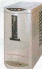
⑪ コーヒークーラー BMC20 ボンマック (2902800) 200X425XH430mm 電源：単相100V 50/60Hz 消費電力：210/250W 最大タンク容量：2.6ℓ 重量：約15kg 冷却能力：約25分 (1.9ℓ) 約85℃→約8℃ ●液面計付。
