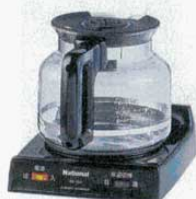
⑨ コーヒーウォーマー NK-112-K ナショナル (3145010) 消費電力: 100W 外寸: 186×213×H190mm 重量: 0.8kg スイッチ: 電源スイッチ(入・切) 保温切り替えスイッチ(高: 100W/低: 50W) 保温温度: 80℃以上(周囲温度20℃で2時間後) コード(長さ): 1.0m ●デカンター付きです。
