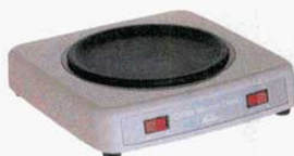
⑩ コーヒーウォーマー カリタ CW-90 (0951100) 消費電力: 90W (高90/低60W) 外寸: 204×207×H52mm 重量: 0.8kg 電源: 単相100V 50/60Hz 保温2段切替 ●ウォーマープレートは、コーヒーが 焦げつきにくいテフロン仕上げ。 ●HiとLowの保温温度選択。
