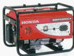
⑧ 発電機 EBR-2300CX 50Hz (7884910) 60Hz (7884920) 外寸: 590×430×H440mm 重量: 45kg 燃料タンク容量: 12ℓ 燃料: 無鉛ガソリン 定格出力: 2.0KVA (50Hz)、2.3KVA (60Hz) 定格電圧: 100V 連続運転時間: 約10.5h (50Hz)、約9.1h (60Hz) 総排気量: 163cc
