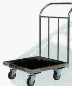
⑦ グラスラックドリー SG-11E 床板付 (1021000) 外寸：615×570×H875mm (内寸515×510mm) キャスター：自在φ100×2 固定φ100×2 材質：ステンレスフレーム
