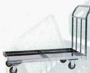
⑪ ツイン型ラックドリー SG-13A 床板付 (1230900) 外寸：1,135×570×H875mm キャスター：自在φ100×2 固定φ100×2 材質：ステンレスフレーム
