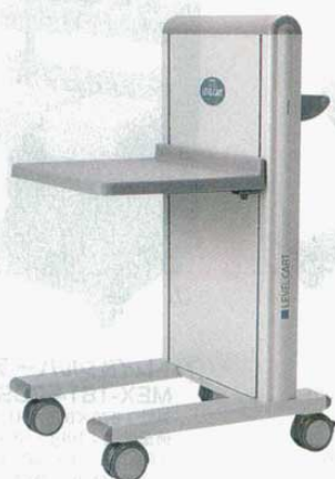
④ レベルカートLVC-04B6 外形：600×640×H1070mm (7723100) トレイ寸法：570×445mm 荷重設定：15・23・32・40kg キャスター：φ60ナイロン双輪キャスター 2輪ストッパー付
