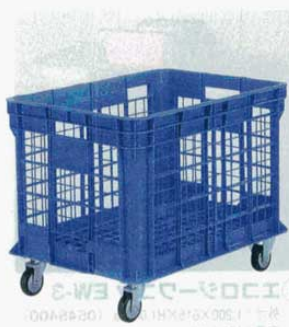
⑥ サンテナーB300 キャスター付 (6662800) 外寸: 925×665×H712mm キャスター: ゴム製φ100 (自在×2、固定×2) 重量: 7.8kg 積載重量: 320kg 材質: ポリエチレン ※ホテルリネン等に便利です。
