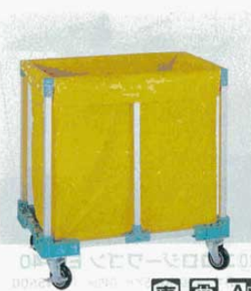
⑤ ターボリンカー (袋付) AP-No200 (4352800) 外寸: 800×500×H780mm ゴム製自在キャスター: φ100×4 (ストッパー2ヶ付) 材質: フレーム/アルミパイプ コーナージョイント/ポリカーボ 使用袋: ナイロンターボリン製 (4352900) 袋サイズ: 720×430×H850mm 重量: 6.5kg 積載重量: 480kg
