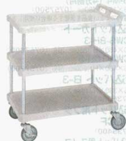
⑨ ユーティリティカート BC1627-34G 外寸: 750×445×H850mm (6685900) BC2030-34G 外寸: 850×540×H850mm (6686000) BC2636-34G 外寸: 1000×685×H850mm (6686100) 材質 棚板: ポリエチレン射出成形 柱: φ25.4mm スチール丸パイプ ニッケル・クロームメッキ仕上 キャスター: φ100mm 4輪自在ポリウレタンエラストマー車/ストッパー無 色: ライトグレー
