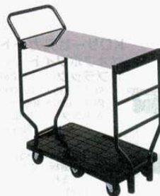
⑨ ミニキャリアL T6-38LR ハンドルH2. H3. L用棚板付 T6-38LR 925×400×H960mm (4355900) 最大荷重：150kgゴムキャスター (6車輪) T-38LR 925×400×H960mm (4356000) 最大荷重：100kgゴムキャスター (4車輪)
