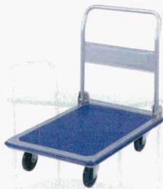
⑩ スチール台車 CSC-150 (ハンドル折りたたみ式) (2307900) 外寸：736×475×H815mm 材質：スチール・シルバメタリック塗装 キャスター：φ100mm×4 (自在×2・固定×2) 最大積載荷重：約150kg
