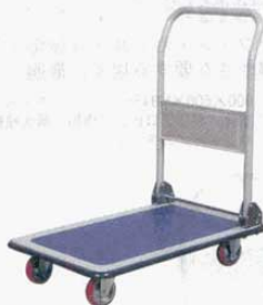
② 台車 NPC(DX) (ハンドル折りたたみ式) ニューポータブルカー (1028000) 外寸：740×480×H850mm 材質：本体/スチール ハンドル/焼付塗装+スチール キャスター：φ100mm×4 (自在×2・固定×2) 最大積載荷重：150kg ※NPCハンドル固定式 (1028100) もあります。
