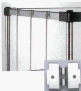
⑫ ソリッド用取付金具 STK (6994100) ※取り付けの際には棚板側面にレンドルで穴を開けて下さい。ボルト、ナットは付属していません。ボルト穴の径はφ7mmです。 ※ソリッドエレクターの側・背面にロッドやレッグを取り付けるための専用金具です。
