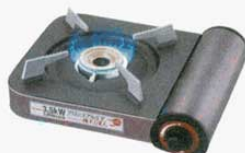
④ カセットフー 強火じまん CB-AL-35 イワタニ (3685000) ⑥ 外寸: 335×302×H97mm 材質: 本体・容器カバー/アルミニウム トッププレート/フッ素プレコート銅板 ガス消費量: 254g/h 連続燃焼時間: 約65分 点火方式: 圧電点火方式 安全装置: 圧力感知安全装置他 容器着脱方式: マグネット方式 最大発熱量: 3.5kW (3,000kcal/h)
