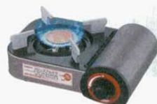
⑨ カセットフー ジュニア CB-JRC-AL イワタニ (3685600) ⑥ 外寸: 247×205×H90mm 材質: 本体/アルミニウム ガス消費量: 150g/h 連続燃焼時間: 約55分 点火方式: 圧電点火方式 安全装置: 圧力感知安全装置他 容器着脱方式: マグネット方式 最大発熱量: 2.1kW (1,800kcal/h) ●従来サイズのボンベも使えます。
