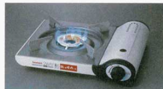
③ カセットフー 2WAY達人 CB-AGP-3 イワタニ (6719610) ⑥ 外寸: 354×310×ロストルH136mm/こんろH98mm 材質: 本体/銅板電着塗装 トッププレート/プレコートフッ素銅板 ガス消費量: 211g/h 連続燃焼時間: 約75分 点火方式: 圧電点火方式 安全装置: 圧力感知安全装置他 容器着脱方式: マグネット方式 最大発熱量: 2.9kW (2,500kcal/h)
