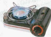
⑩ カセットフー ジュニア CB-JRC-ST イワタニ (3685700) ⑥ 外寸: 244×202×H93mm 材質: 本体/アルミニウム ガス消費量: 152g/h 連続燃焼時間: 約55分 点火方式: 圧電点火方式 安全装置: 圧力感知安全装置他 容器着脱方式: マグネット方式 最大発熱量: 2.1kW (1,800kcal/h) ●従来サイズのボンベも使えます。
