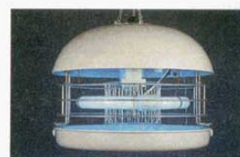
⑨ 電撃殺虫器 TRS-32111 (6250000) 外寸: φ428×317mm チェーン82cm 定格電圧: 100V 円形捕虫ランプ32W×1灯 有効面積: 150~300㎡ OUT DOOR 重量: 8.5kg 用途: 店舗出入口
