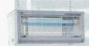
⑥ シュアー屋内用電撃殺虫器 GK-4010DX (1127100) 外寸: 592×304×H270mm 材質: ステンレス ●取付高さ床1.8m以上 ●二重安全装置付き(虫受け皿、保護カバー) ●チェーン吊り下げ式
