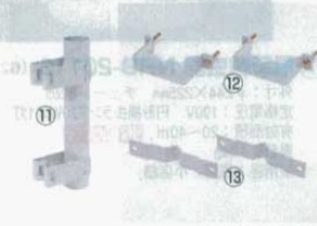
屋外用電撃殺虫器 GK-7010用取付金具 ⑪ GP-701 (側取付金具) (1128700) ⑫ GP-702 (壁取付金具) (1128800) ⑬ GP-703 (角・丸ポール側取付金具) (1128900) ●コンクリート柱などの側付けには⑪を御使用ください。 ●壁面などの取り付けには⑫・⑬を御使用ください。 ●その他(丸ポールφ89/101mm・角ポール100mmなど)には⑫・⑬を御使用ください。
