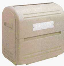
⑩ワイドベール 500 容量: 560ℓ 排水口付 材質: ポリエチレン ●耐衝撃性に優れた2重構造 キャスター付 (5651800) 1,050×676×H1,040mm キャスター: φ75mm×4自在 2輪ストッパー付 キャスター無 (5651700) 1,050×676×H988mm
