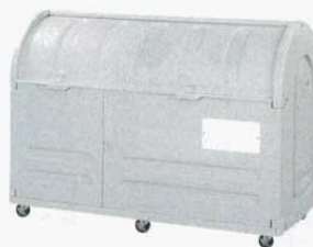
③ステーションボックス #800C キャスター付 エコランド 1,560×734×H1,120mm (8534600) 容量: 800ℓ キャスター: φ75mm×6自在 3輪ストッパー付 材質: ポリエチレン
