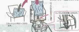
■カートリッジのディスペンサー(容器)へのセット方法 ディスペンサー(容器)にセットする。
