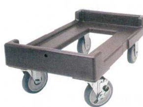
⑭ピザ生地 ボックス用カムドローリー CD1826PDB 4134300 外寸：700×498×H268 内寸：630×430 キャスト：φ127×2自在 (内1個ストッパー付) φ127×2固定 積載能力：136kg 材質：ポリエチレン
