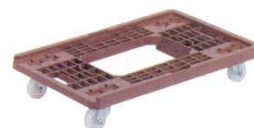
⑬ サンキャリー PF サンコー ブラウン 外寸: 643×419×H119 8209800 キャスター: φ65 4輪自在 ナイロン車 耐荷重: 120kg 材質: ポリプロピレン ※大型番重用です。
