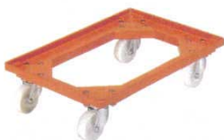
⑭ サンキャリー 2B サンコー 外寸: 582×397×H143 4862200 5 キャスター: φ85 4輪自在ストッパー 無し ウレタン製 耐荷重: 120kg 材質: ABS樹脂 ※小型番重用です。
