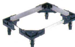
⑫ サンキャリー フリー SL2 サンコー 超特大番重用 8778900 外寸: 670×459×H146 内寸: 646×435 特大番重用 8779000 外寸: 680×425×H146 内寸: 670×415 大型番重用 8209700 外寸: 673×449×H146 内寸: 649×425 小型番重用 3758200 外寸: 587×401×H146 内寸: 563×377 ※キャスター: φ75 4輪自在 ナイロン車 ※耐荷重: 210kg ※材質: 対衝撃PP+アルミ
