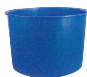
⑬丸型槽 MH-1200 5220300 外寸：φ1,450×H930 内寸：φ1,340×H920 容量：約1,200ℓ 本体重量：30kg 肉厚：9mm 材質：ポリエチレン
