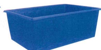
⑧角型槽 KH-1500 8433000 外寸：1,920×1,375×H725 内寸：1,800×1,240×H700 底寸：1,650×1,150 容量：約1500ℓ 本体重量：40kg 肉厚：8mm 材質：ポリエチレン
