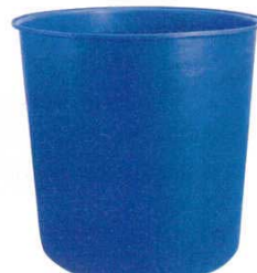
⑫丸型槽 MH-900 5220200 外寸：φ1,170×H1,070 内寸：φ1,100×H1,060 容量：約900ℓ 本体重量：25kg 肉厚：6mm 材質：ポリエチレン
