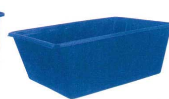
⑥角型槽 KH-700 5220500 外寸：1,580×1,040×H580 内寸：1,500×950×H560 底寸：1,200×880 容量：約700ℓ 本体重量：22kg 肉厚：6mm 材質：ポリエチレン
