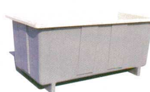
④ジャンボタンク 1070S 8433200 外寸：1,770×1,150×H760 内寸：1,650×1,030×H660 容量：約1070ℓ 本体重量：35kg 材質：FRP 規格色：ホワイト・グレー 脚間隔：1,000mm
