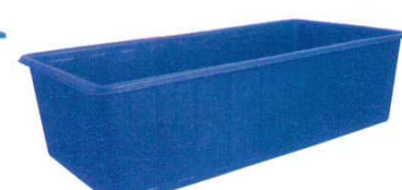
⑨角型槽 KH-2000 8433100 外寸：2,580×1,240×H695 内寸：2,490×1,130×H680 底寸：2,280×990 容量：約2000ℓ 本体重量：55kg 肉厚：8mm 材質：ポリエチレン
