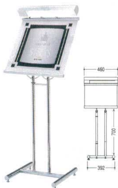
①店頭スタンド ライティングディグリーⅡ 7699910 パネルサイズ: 450×H450 材質: 本体/スチール製 パネル/アクリル 電源: 単相100V・40W、スイッチ付 ランプ: 40Wキセノンボールランプ (E-17)、2.5mコード付
