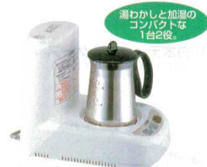
⑪湯沸かし器 CIH-A060 (加湿機能付) IHタイガー 7321900 [A] 183×272×H232 電源: 単相100V 50/60Hz 消費電力: 湯沸時 600W、加湿時 60W ●サーバー容量 500cc (300、500cc目盛付) 湯水の水で約8分、沸きあがりをプザーで知らせ、自動的に電源OFF。空だき防止装置付 ●加湿容量: 700cc、加湿時間は約8時間。 ●加湿中に湯わかしもできます。
