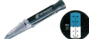
⑪濃度計 MASTER-20T 屈折計 自動補正式 外寸：33×33×H204 8368410 測定範囲：Brix0.0～20.0% 最小目盛：Brix0.1% ※用途：果実類、低濃度用のトマト果汁・ スープ・だし汁・洗剤の測定に適 しています。自動温度補正機能付 きます。
