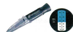
⑫濃度計 MASTER-53T 手持屈折計 外寸：33×33×H168 5503810 重量：120g 測定範囲：Brix0.0～53.0% 最小目盛：Brix0.5% 測定精度：Brix±0.5%（10～30℃） 繰り返しし性：Brix±0.25% ※用途：果汁/清涼飲料/炭酸飲料/缶詰 シロップ/スープ
