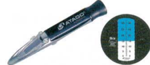
⑦濃度計 MASTER-T 手持屈折計 外寸：33×33×H204 0415200 測定範囲：Brix0～32% 最小目盛：0.2% ※用途：果実・果汁飲料・炭酸飲料・豆乳・ 乳酸飲料などの糖分チェックにご 利用下さい。 ※自動補正式
