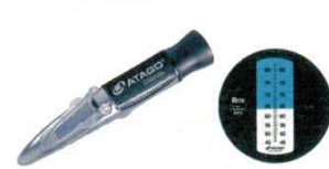
④濃度計 MASTER-4M 手持屈折計 外寸：33×33×H168 0415510 測定範囲：Brix45～82% 最小目盛：0.2% ※用途：中濃度から高濃度までの広い測定 範囲をもったタイプです。煮豆・ コンデンスミルク・5倍以上の濃 縮果汁・ジャム・マーマレード・ 液糖などにご利用下さい。
