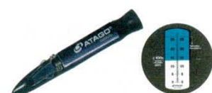
⑤食塩水濃度計 MASTER-S28M 外寸：33×33×H204 8339010 重量：100g 測定範囲：食塩水濃度 0.0～28.0% 最小目盛：食塩水濃度 0.2% ●漬物仕込み時、海産物の食塩水濃度測定 に活躍できます。
