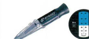
⑬濃度計 MASTER-50H 手持屈折計 外寸：33×33×H168 8368800 重量：120g 測定範囲：Brix0.0～50.0% 最小目盛：Brix0.5% 耐熱強化、防水機能、自動温度補正機能 ※用途：従来タイプに比べ耐熱性を強化したタイプ です。製造現場で煮詰めながら製造してい るサンプルを高温のまま測定できます。た れ・佃煮・煮汁に最適です。
