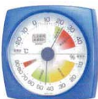
⑭ エンベックス 生活管理温・湿度計 TM-2436 132×121×H50 3426300 質量：約130g 測定範囲：温度-20～40℃ (2℃) 湿度10～90% (5%) 材質：ABS樹脂 卓上用ですが、台をとれば壁掛けになります。
