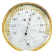
⑩ 温湿度計 ハーモニー φ150 0406800 [10] 測定範囲：温度-30℃～+50℃ (2℃) 湿度20%～100% (5%)
