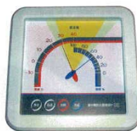
③ 温湿度計 厨房用 230×230 3061500 測定範囲：温度-10℃～+40℃ (2℃) 湿度0%～100% (5%) ※食中毒ゾーン付
