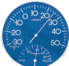
① 温湿度計 TM-108 シチズン 300×300×H39 3426200 質量：610g 測定範囲：温度-30～50℃ (2℃) 湿度0～100% (5%) 材質：枠/プラスチック 風防/ガラス製
