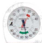
⑮ 温湿度計 チャーミー P-2 70380 120×120×H30 2933100 質量：100g 測定範囲：温度-20～40℃ (2℃) 湿度15～100% (5%) 材質：目盛板カバー/スチロール 快適温度、快適湿度ゾーンに色がついており、健康管 理や省エネに役立つ温湿度計です。 本体ケースには抗菌剤入りプラスチックを採用。
