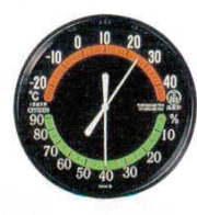
⑧ 温湿度計 TM-42-3 黒 φ150 5495700 プラスチック枠 測定範囲：温度-20℃～+40℃ (2℃) 湿度10%～90% (5%)
