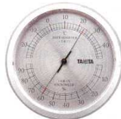
⑪ 温湿度計 TT-512 シルバー φ140×30 0859400 質量：約120g 測定方式：バイメタル式 表示方法：指針 設置：掛式 測定範囲：温度-20～40℃ (2℃) 湿度10～90% (5%)
