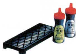
⑤ 砥石修正器「なおる」セラミック 外寸：245×100×H25 4236200 ●中・荒パウダー各1本付 ●わずかな凹凸の場合は付属の中目パウダー 4236300 極端な凹凸の場合は付属の荒目パウダー 4236400 の 使用で早く仕上がります。カバド専用台にセットで き、あらゆる砥石の修正にお使いいただけます。 別売で細目パウダー 6661600 もございます。
