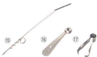
⑮ ポテトスパイラル 全長: 240 2735300 ※ポテトのタテ軸方向にネジ込んで、先端の丸いナイフがもう一方の側から見えるまでおし込んで下さい。それからカット・アウトスパイラルの部分をかき出してナイフを廻しながら展します。(そのまま引っ張らないように！)
