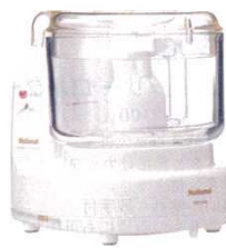
③ フードプロセッサー MK-K48-W ナショナル 8709210 外寸: 225×155×H190 容量: 最大500g (ハンバーグのたね) 重量: 2.6kg 電源: 単相100V 120W ※あらびきスイッチはついていません
