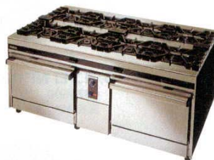
⑦ ガスレンジ OZ2LB-180R 両面式 ●オープンは中がトンネル状ですので、厨房室の中央に設置すれば両側から使用出来ます。 ※オープンは立消え安全装置付。
