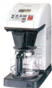
⑪ コーヒーブルーワー カルド BM-3000 ボンマック 4014400 外寸：200×410×H430 重量：7.8kg 電源：単相100V 消費電力：1,080W(湯沸かし980W、温 風保温100W) タンク容量：2.7ℓ 能力：9.6ℓ/h 付属品：専用デカンタ BCD-18-2B(専用蓋付) 水差し(容量：2ℓ) ペーパーフィルター (No.250)・25枚 ●温風ヒーターでデカンタ全体を保温するの で、コーヒーの煮詰まりを防ぎ、美味しさ 長持ち。
