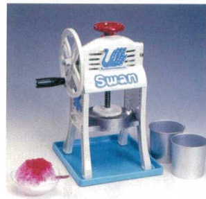
⑭氷削機 手動式 ミニ ちいさな南極 8455500 外寸: 220×202×H395 氷削能力: 0.7kg/分 円盤有効径: φ120 重量: 8.5kg 付属品: 氷受皿1枚、製氷カップ2コ 製氷カップ: 1コ当たり容量約500ml
