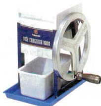
⑧アイスクラッシャー HA-1600 手動式 初雪 0984100 外寸: 315×260×H313 能力: 最小粗さ0.8kg/分 (12mm/塊) 最大粗さ1.8kg/分 (20mm/塊) 重量: 6kg ※クラッシュの粗さ2段階切り替え
