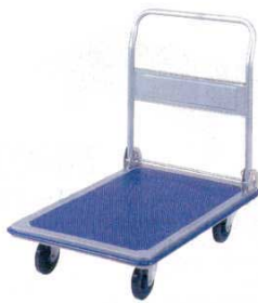
⑩スチール台車 CSC-150 (ハンドル折りたたみ式) 2307900 外寸: 736×475×H815 材質: スチール・シルバーメタリック塗装 キャスター: φ100×4 (自在×2・固定×2) 最大積載荷重: 約150kg
