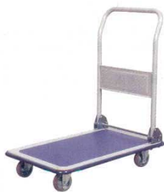
②台車 NPC(DX) (ハンドル折りたたみ式) ニューポータブルカー 1028000 外寸: 740×480×H850 材質: 本体/スチール ハンドル/焼付塗装+スチール キャスター: φ100×4 (自在×2・固定×2) 最大積載荷重: 150kg ※NPCハンドル固定式 1028100 もあります。
