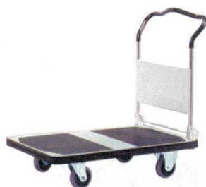
⑤台車 プレミアムダンディ (ハンドル折りたたみ式) PDA-LSC-MS 6332900 外寸: 900×600×H925 材質: スチール・ゴムマット キャスター: φ125×4 (自在×2・固定×2) 最大積載荷重: 300kg ※ユニバーサルデザイン採用の使いやすい ハンドル。
