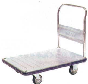
⑨台車 SA-LS (ハンドル固定式) ダンディー 6635300 外寸: 920×620×H922 材質: 本体・ハンドル/ステンレス キャスター: φ130×4 (自在×2・固定×2) 最大積載荷重: 300kg
