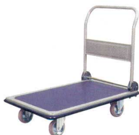
①台車 NFC(DX) (ハンドル折りたたみ式) ニューフレンドカー 1028300 外寸: 900×600×H850 材質: 本体/スチール ハンドル/焼付塗装+スチール キャスター: φ130×4 (自在×2・固定×2) 最大積載荷重: 300kg ※NFCハンドル固定式 1028400 もあります。
