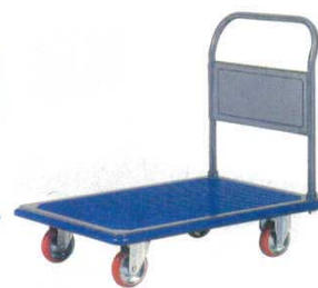
④台車 アイケーキャリー 302 (ハンドル固定式) 1028620 外寸: 900×600×H850 材質: 本体・ハンドル/スチール マット/塩ビ キャスター: φ130 (自在×2・固定×2) 最大積載荷重: 300kg
