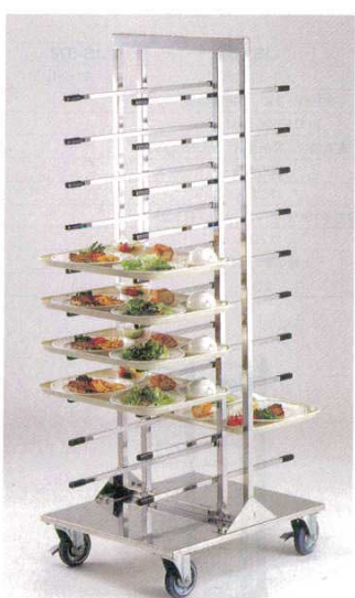
④ ディッシュスタック トレイ用 EBM 600×600×H1,760 4111300 バーの長さ: 320mm バーは最大482mm (W) から50mmきざみで最小182mm (W) まで移動します。 両面で20枚のトレイがのります。 ※キャスターφ150 4輪自在 (内2ヶストップバー付)
