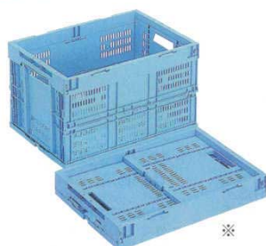
① コンテナー CB-M50W 折りたたみ式 3072800 [5] 外寸: 530×366×H325 内寸: 492×334×H314 折りたたみ時: 530×366×H86 容量: 50ℓ 材質: ポリプロピレン
