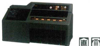
⑨ 硬貨選別計数機 DC-9 勘太 5439000 外寸：470×210×H257 電源：単相100V 50/60Hz 重量：8.0kg 計数金種：国内発行硬貨6金種 計数速度：450枚/分(1円、50円硬貨計数時) ホッパー容量：100円硬貨時 400枚 計数処理：混合硬貨を選別・計数し、金種別にコインボックスへ収納 表示器：数字表示器6桁、トータルランプ1個、金種モニターランプ6個 表示内容：金種別枚数、金額、合計金額、金種別総枚数、総金額、総合計金額 諸機能：オートストップ機能、カバーオープストップ機能、レールワイパー機能、パッチ機能(設定は3パターン可、50枚固定、全金種任意枚数、硬貨種別任意枚数) ※プリンター機能を御希望の方は DC-9P勘太(プリンター付) をお求めください。
