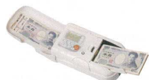
⑨ 硬貨選別計数機 DC-9 勘太 5439000 外寸：470×210×H257 電源：単相100V 50/60Hz 重量：8.0kg 計数金種：国内発行硬貨6金種 計数速度：450枚/分(1円、50円硬貨計数時) ホッパー容量：100円硬貨時 400枚 計数処理：混合硬貨を選別・計数し、金種別にコインボックスへ収納 表示器：数字表示器6桁、トータルランプ1個、金種モニターランプ6個 表示内容：金種別枚数、金額、合計金額、金種別総枚数、総金額、総合計金額 諸機能：オートストップ機能、カバーオープストップ機能、レールワイパー機能、パッチ機能(設定は3パターン可、50枚固定、全金種任意枚数、硬貨種別任意枚数) ※プリンター機能を御希望の方は DC-9P勘太(プリンター付) をお求めください。
