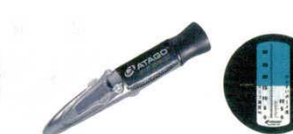
⑮濃度計 MASTER-93H 手持屈折計 外寸：33×33×H168 8339110 重量：120g 測定範囲：Brix45.0～93.0% 最小目盛：Brix0.5% 測定精度：Brix±0.5% 自動温度補正・防水機能付（高温対応） ※用途：はちみつ／水飴／ジャム／餡／油 脂／コンデンスミルク ●Hシリーズは、自動温度補正・防水機能 に加え、耐熱性を強化しました。煮詰め ながらの高温サンプルの測定に最適です。
