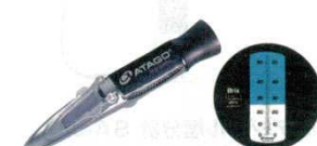
⑫濃度計 MASTER-53T 手持屈折計 外寸：33×33×H168 5503810 重量：120g 測定範囲：Brix0.0～53.0% 最小目盛：Brix0.5% 測定精度：Brix±0.5%（10～30℃） 繰り返し性：Brix±0.25% ※用途：果汁／清涼飲料／炭酸飲料／缶詰 シロップ／スープ
