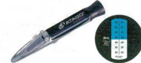
⑧濃度計 MASTER-2T 手持屈折計 外寸：75×55×H210 0415300 測定範囲：Brix28～62% 最小目盛：0.2% ※用途：中濃度のサンプルに適したタイプ。 濃縮果汁・煮豆・缶詰・きんとん などにご利用下さい。 ※自動温度補正機能付（10～30℃）
