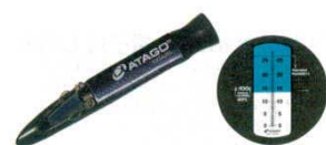
⑤食塩水濃度計 MASTER-S28M 外寸：33×33×H204 8339010 重量：100g 測定範囲：食塩水濃度 0.0～28.0% 最小目盛：食塩水濃度 0.2% ●漬物仕込み時、海産物の食塩水濃度測定 に活躍できます。
