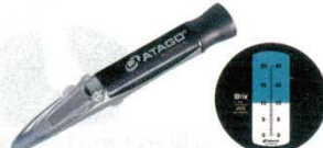
⑪濃度計 MASTER-20T 屈折計 自動補正式 外寸：33×33×H204 8368410 測定範囲：Brix0.0～20.0% 最小目盛：Brix0.1% ※用途：果実類、低濃度用のトマト果汁・ スープ・だし汁・洗剤の測定に適 しています。自動温度補正機能付 きです。
