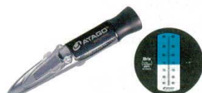
⑨濃度計 MASTER-3T 手持屈折計 外寸：33×33×H168 1727900 測定範囲：Brix58.0～90.0% 最小目盛：Brix0.2% 測定精度：Brix±0.2%（10～40℃） ●みずあめ・はちみつ・煮豆・コンデンス ミルク・ジャム・マーレード・液糖な どの測定に！ ●自動温度補正ですので、室温を気にせず に測定できます。
