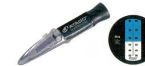
⑭濃度計 MASTER-80H 手持屈折計 外寸：33×33×H168 8368700 重量：120g 測定範囲：Brix30.0～80.0% 最小目盛：Brix0.5% 耐熱強化、防水機能、自動温度補正機能 ※用途：H-50と同じく耐熱性を強化した タイプです。ジャム・マーレード・ 給などの測定に適しています。強 化プリズムの採用により、ジャム などに含まれている酸による腐食 を抑え、寿命が長くなりました。
