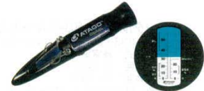
⑥濃度計 MASTER-めんつゆM 手持屈折計 外寸：33×33×H168 0415110 重量：90g 測定範囲：汁濃度 0.0～56.0% 食塩水濃度 0.0～28.0% 最小目盛：汁濃度 1.0% 食塩水濃度 1.0% ●そば、うどん専用目盛を持った濃度計です。 食塩水、返し、辛汁、甘汁の目盛が表示 されています。
