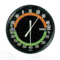
⑧ 温度計 TM-42-3 黒 φ150 5495700 プラスチック枠 測定範囲：温度-20℃～+40℃ (2℃) 湿度10%～90% (5%)
