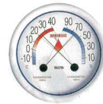
⑥ 温度計 No.5488 食中毒注意ゾーン付 φ180×H32 6815400 ⑩ 測定範囲：温度-10℃～40℃ (5℃) 湿度10%～90% (5%) 温度と湿度による食中毒の発生を、未然に 防止する為の目安に最適。 ※食中毒注意範囲をレッドゾーン表示
