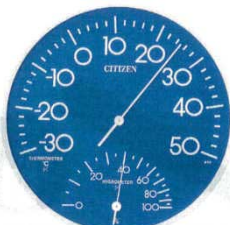
① 温度計 TM-108 シチズン 300×300×H39 3426200 質量：610g 測定範囲：温度-30～50℃ (2℃) 湿度0～100% (5%) 材質：枠/プラスチック 風防/ガラス製
