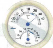
④ 温度計 TT-513 WH (ホワイト) φ182×32 2867120 質量：約230g 測定範囲：温度-20～40℃ (2℃) 湿度10～90% (5%)
