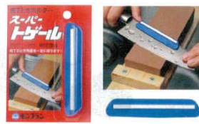
⑰ 庖丁研ぎ器「スーパートゲール」 全長：100×厚み15 6503100 材質：クリップ部/ナイロン 砥石に当たる部分/アルミナ系セラミック ●庖丁の研ぎ角度を固定し、一定の角度で簡単に研ぎます。 ※庖丁の背の厚さが3mm迄のものにご使用下さい。
