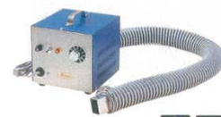
⑰ 火おこしファン 1015300 外寸: 180×180×H180 電源: 単相100V 50/60Hz 消費電力: 23/25W 温度調節: ファン調節(無段階調節) コード長さ: 1.8m ホース長さ: 1m 付属品: ホースバンド×2、口金×1 質量: 5kg ●スピーディーに炭を起こします。
