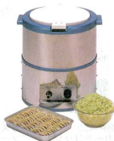
⑤野菜脱水機 VS-250N プロシェフ(卓上型) 0804700 寸法：430×388×H457 電源：単相100V 50/60Hz 定格消費電力：130/145W 定格時間：連続 重量：26kg ●タイマースイッチ付(最長15分) ●4kgタイプ ※絞り袋付 ※約2分でキャベツなら3kgを脱水することができます。
