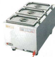
⑤ ウォーマー ES-5WT タテ型 電気式 18-8 エイシン 0869200 単相100V 1kW 収容量: 4.5ℓ×3 (ホテルパン1/4) 温度調節: 30℃~100℃ サーマ可変式 外寸: 320×550×H300 ※ヨコ型の ES-5W 0869300もあります。
