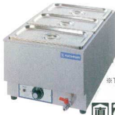
⑨ ウォーマー TEW型 卓上(湯煎式) 外寸: 350×550×H260 電源: 単相100V 900W リード線2m・プラグ付: 2P-15A 排水コック: 15A 重量: 14kg ※組合せパターンは、右の表より、お選び下さい。
