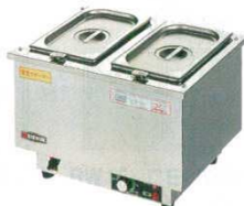
④ ウォーマー ES-3W ヨコ型 電気式 18-8 エイシン 0869000 単相100V 750W 収容量: 4.5ℓ×2 (ホテルパン1/4) 温度調節: 30℃~100℃ サーマ可変式 外寸: 420×320×H300 ※タテ型の ES-3WT (排水バルブ付) 0869100もあります。
