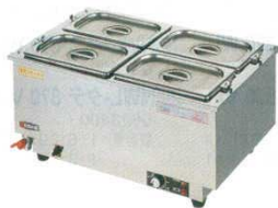
③ ウォーマー ES-1W ヨコ型 電気式 18-8 エイシン 0868900 単相100V 750W 収容量: 4.5ℓ (ホテルパン1/4) 温度調節: 30℃~100℃ サーマ可変式 外寸: 320×210×H285
